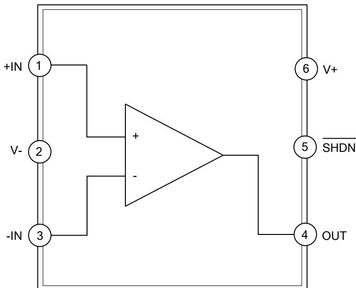
■ INTERNAL SIMPLE CIRCUIT(AMPLIFIERS SECTION)
